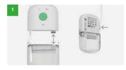
Anslut behållaren till pumpen genom att trycka på behållaren tills ett klickljud hörs på båda sidor. Fäst behållarslangen i klämman på baksidan.
