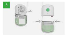
Lossa slangen på baksidan av pumpen. Tryck hårt på de sidomonterade plastflikarna och dra samtidigt som du vickar försiktigt för att koppla loss behållaren. Anslut den nya behållaren. Behållaren ska sitta ordentligt fast, vilket är normalt och nödvändigt för att upprätthålla en effektiv förslutning.
