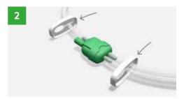
Skjut fram slangklämmorna så att de hamnar nära de gröna kopplingarna och tryck båda klämmorna över slangen för att säkerställa att inget vätskeläckage förekommer vid bortkoppling.
