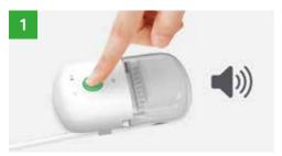
Pausa pumpen genom att trycka på den gröna startknappen och släpp den sedan efter två (2) sekunder. Pumpen avger två pip för att bekräfta att den är i pausläge.
